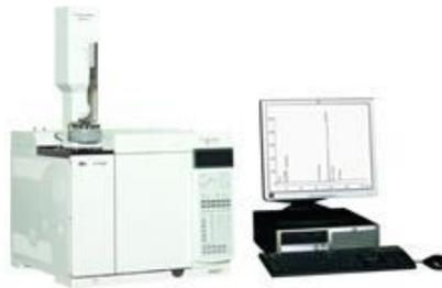
**Chromatographe en phase gazeuse** pour l'analyse du gaz naturel selon les normes GPA 2286-02, ASTM D2421, ASTM D2598, ASTM D3588, ISO 6976 and GPA 2172
