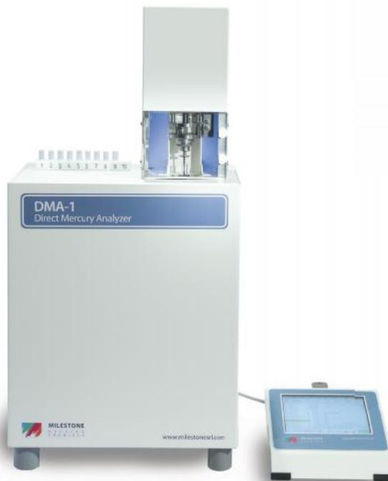
Analyseur de mercure permet une analyse sans préparation au préalable des échantillons liquides, solides et gazeux
