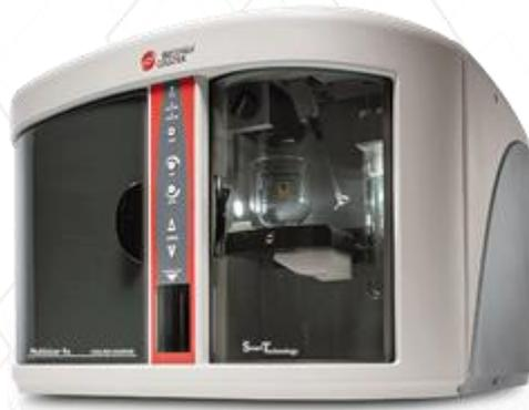
**Compteur de particules** avec une détection tridimensionnelle qui permet de mesurer le volume exacte de la particule ou de la cellule (indépendamment de la forme, de la couleur et de l'indice de réfraction.)
